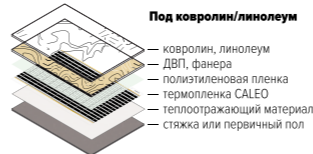
Рис. Схема монтажа теплого пола CALEO под ковролин или линолеум
