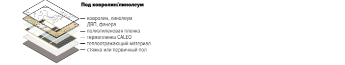
Рис. Схема монтажа теплого пола CALEO под ковролин или линолеум
