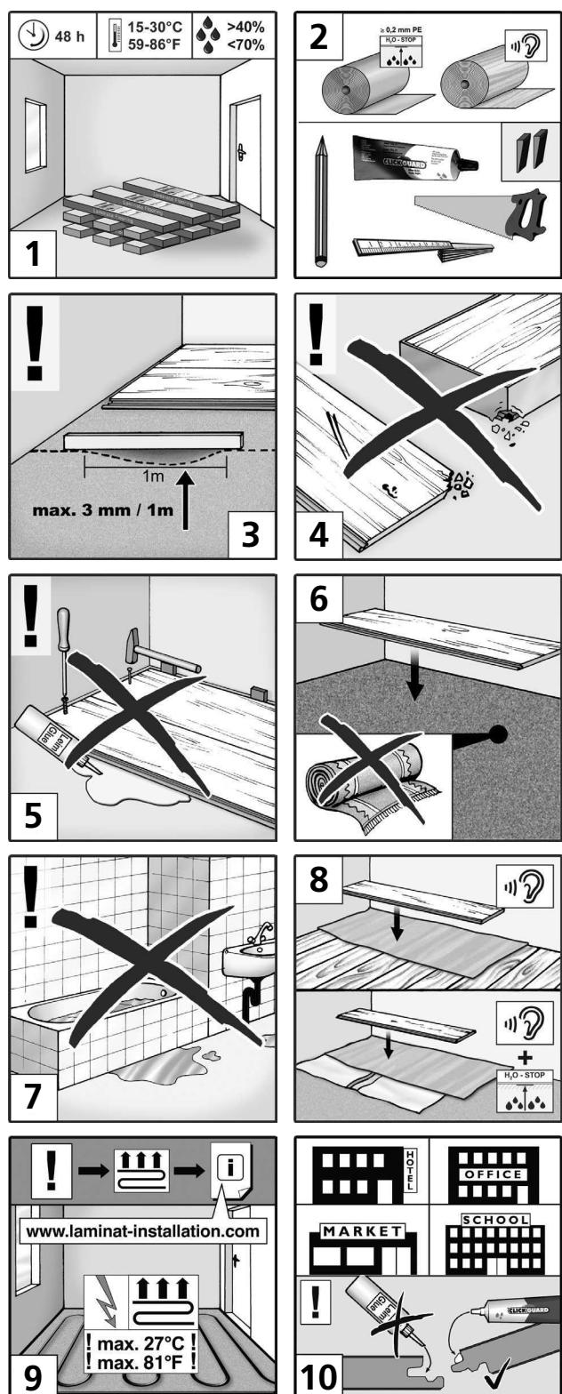
**Подготовка:** Выдержите, пожалуйста, пакеты в течение 48 часов перед укладкой при тех же климатических условиях, что и при укладке [1]. Важной предпосылкой для монтажа и длительного поддержания ламинатного пола в сохранности является климат в помещении с температурой прим. 20°C и относительной влажностью воздуха 50 - 70%.
